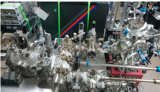
パルスレーザー堆積 / 超高真空原子間力顕微鏡複合装置
