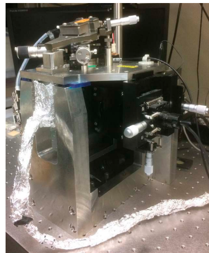
バイオ試料観察用高速原子間力顕微鏡
