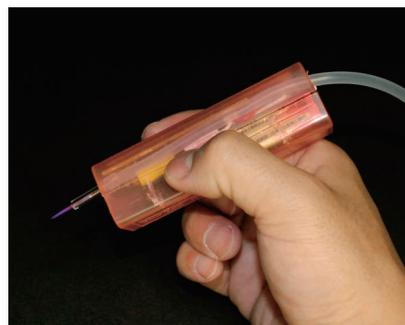
ハンディータイプの LF プラズマジェット装置。内蔵している乾電池で動作可能です。
