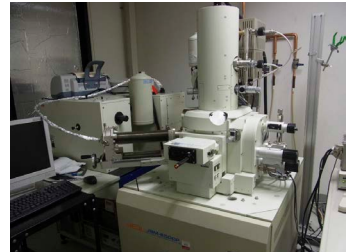
走査型電子顕微鏡システム（カソードルミネッセンス測定装置及びエネルギー分散型 X 線分光装置を一体化） 可変温度：10-300K 空間分解能：10nm 以下
