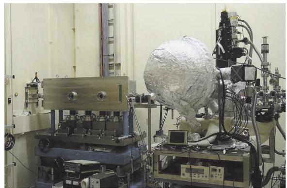
Fig. 2 高輝度シンクロトロン放射光施設 SPring-8 BL19LXU に設置した硬 X 線光電子分光装置
