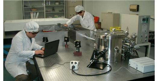
図2 レーザー損傷試験装置.
