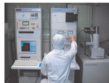
光集積回路など微細構造の作製に用いる電子ビーム描画装置。
