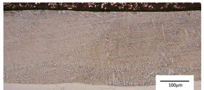
フレキシブルプロファイルレーザシステムによるクラッディング
